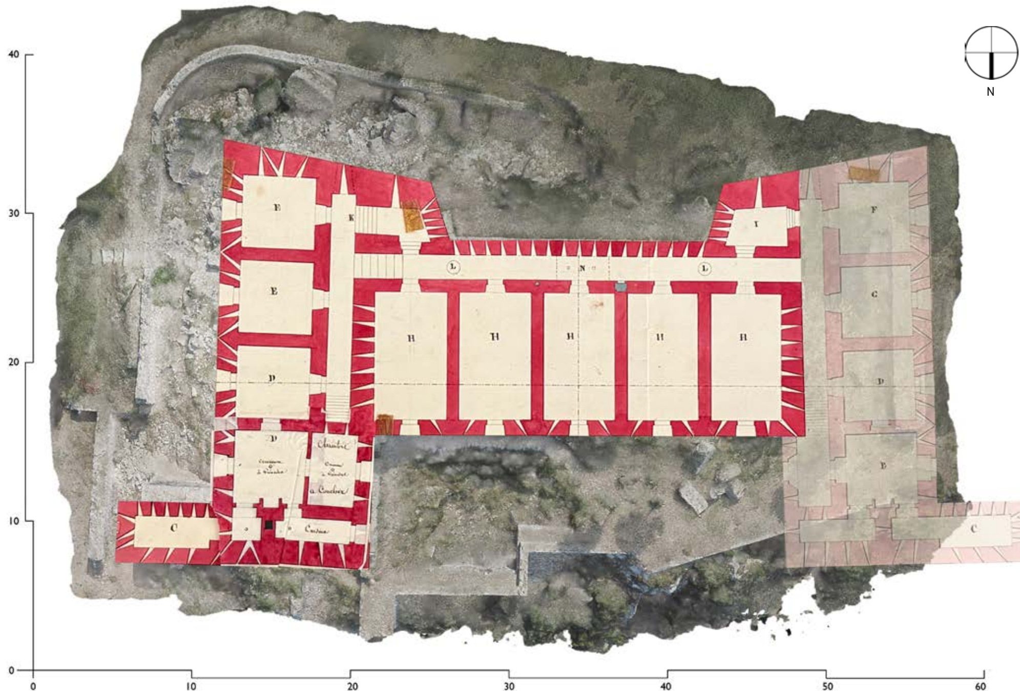
Fig. 138 – Sovrapposizione tre l'ortofoto e il progetto del 1813, evidenziando come la parte colorata di rosa non possa essere eseguita perché aggettante sulla scogliera.
