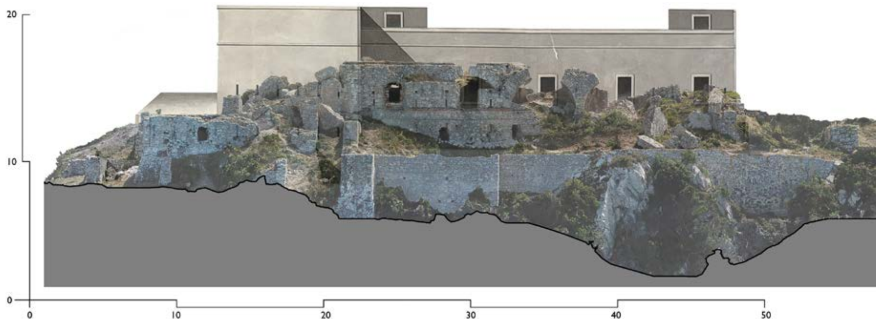
Fig. 144 – Sovrapposizione dell'ortofoto del prospetto nord, rilievo eseguito nel 2023, sul disegno progettuale rivisto in base a quanto effettivamente eseguito. Fig. 144 – Overlay of 2023 north elevation orthophoto on the revised project drawing based on what was actually built.
