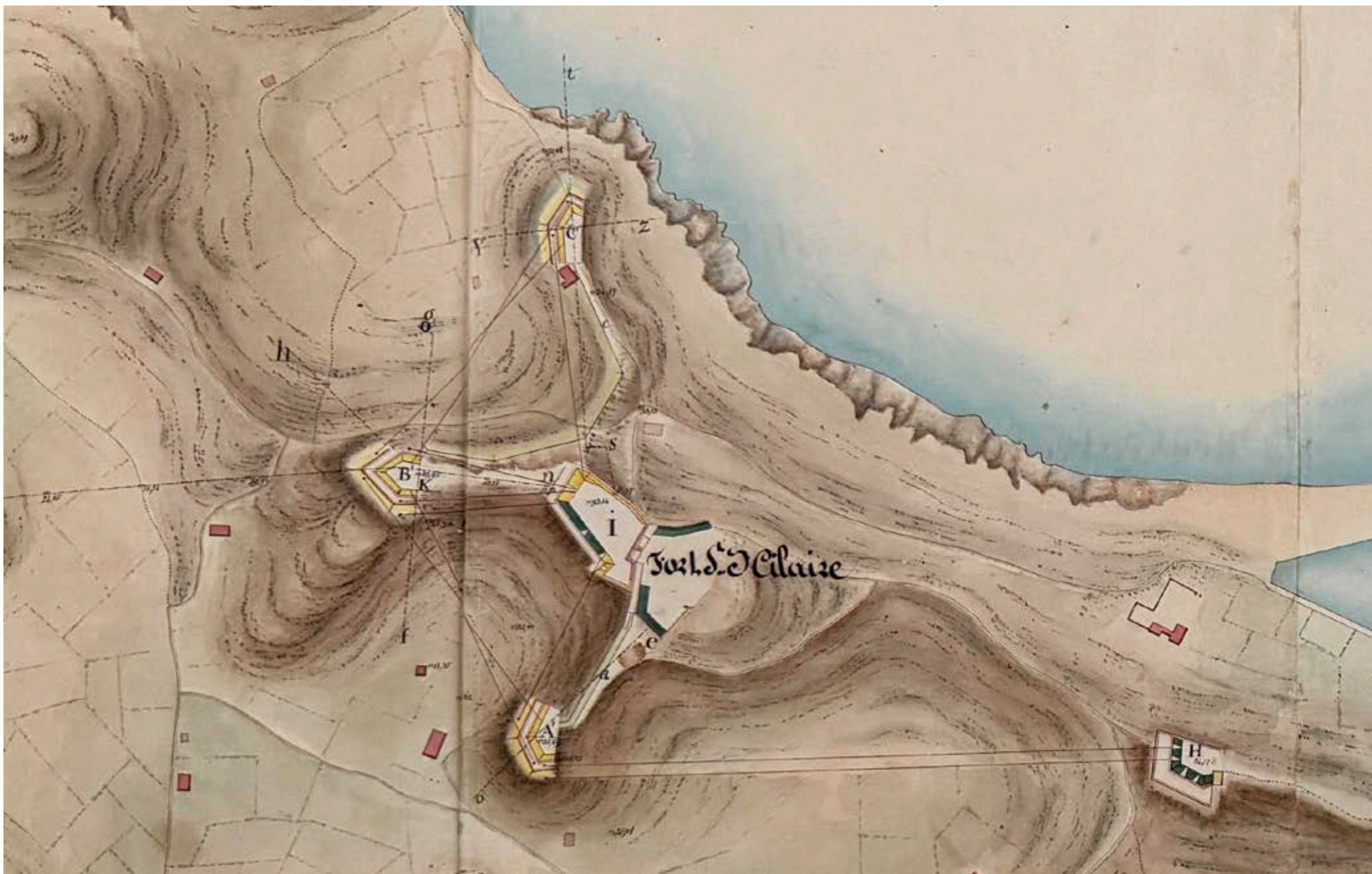
Fig. 52 – Particolare della cartografia con il progetto delle fortificazioni, previste dai francesi. Intorno a Forte Inglese viene prevista una corona di “ridotte”. Anno 1809. Istituto Storico e di Cultura dell’Arma del Genio di Roma (ISCAG).
