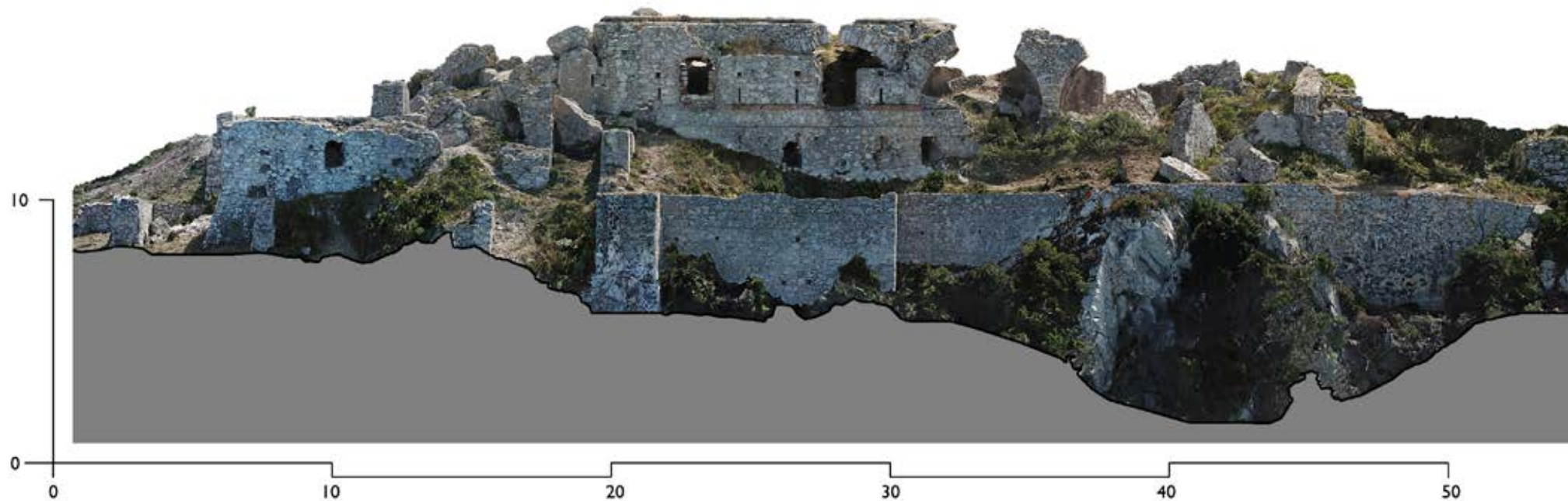
Fig. 139 – Ortofoto prospetto nord del rilievo eseguito nel 2023.
