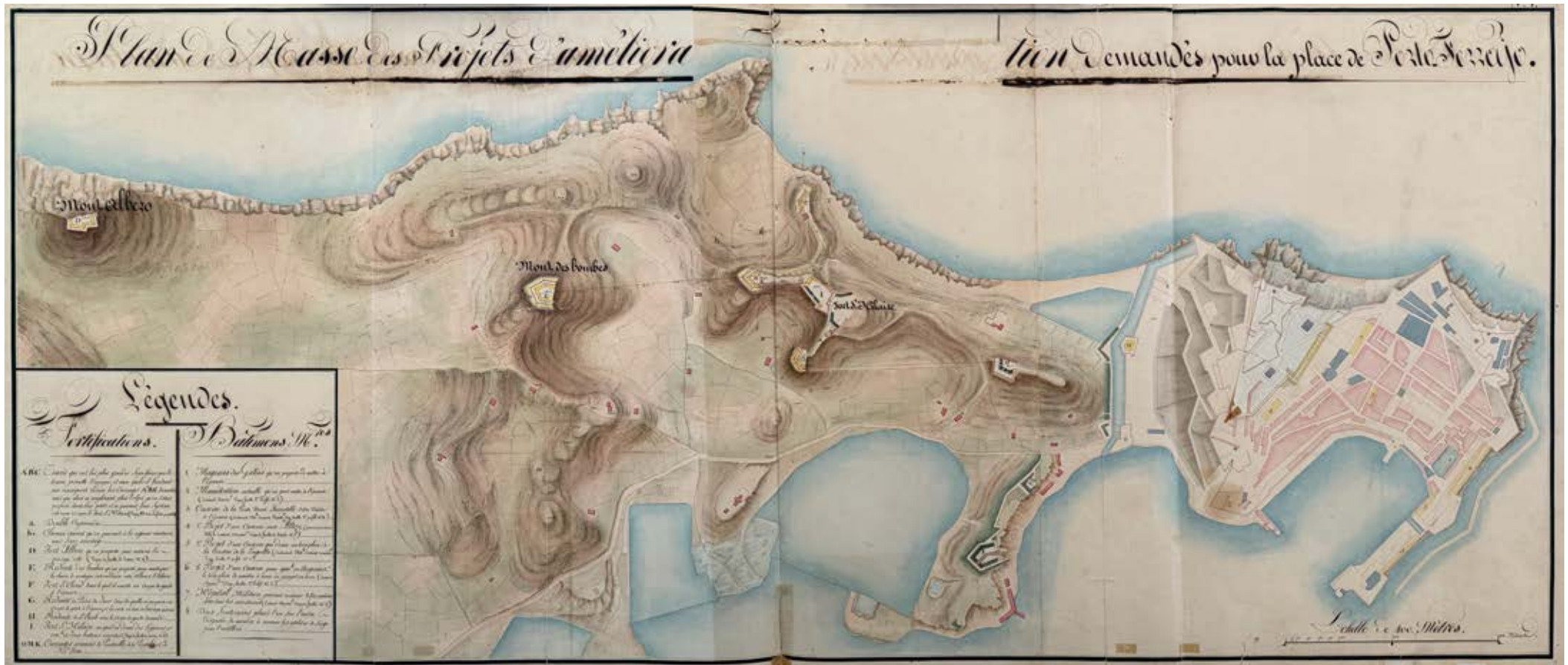
Fig. 27 – Cartografia con il progetto di ulteriori fortificazioni, come Monte delle Bombe e una corona intorno a Fort Hilarie. Anno 1809. Istituto Storico e di Cultura dell'Arma del Genio di Roma (ISCAG).
