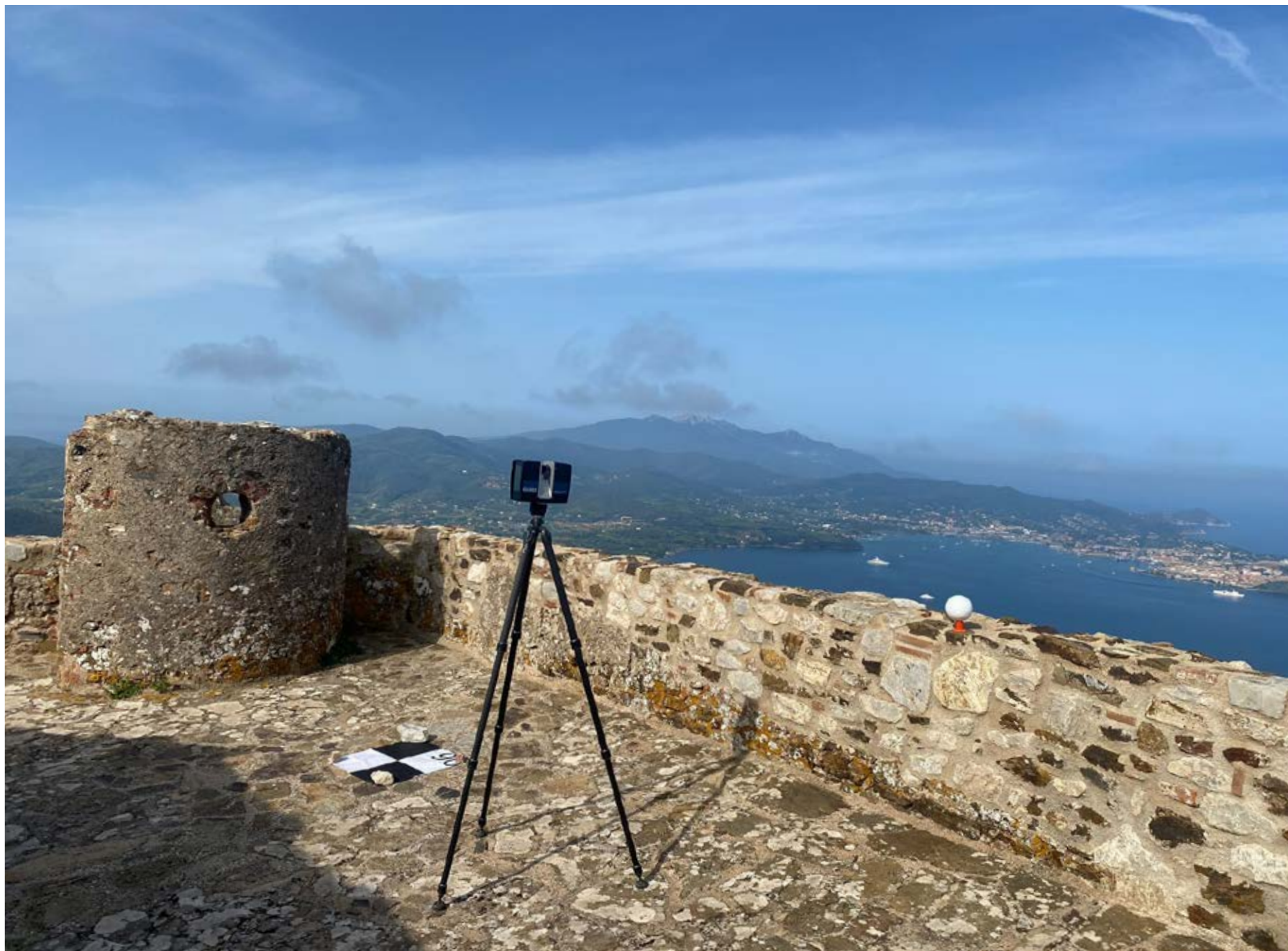
Fig. 4 – Processo di acquisizione con TLS e fotogrammetria da drone della Fortezza del Volterraio.
