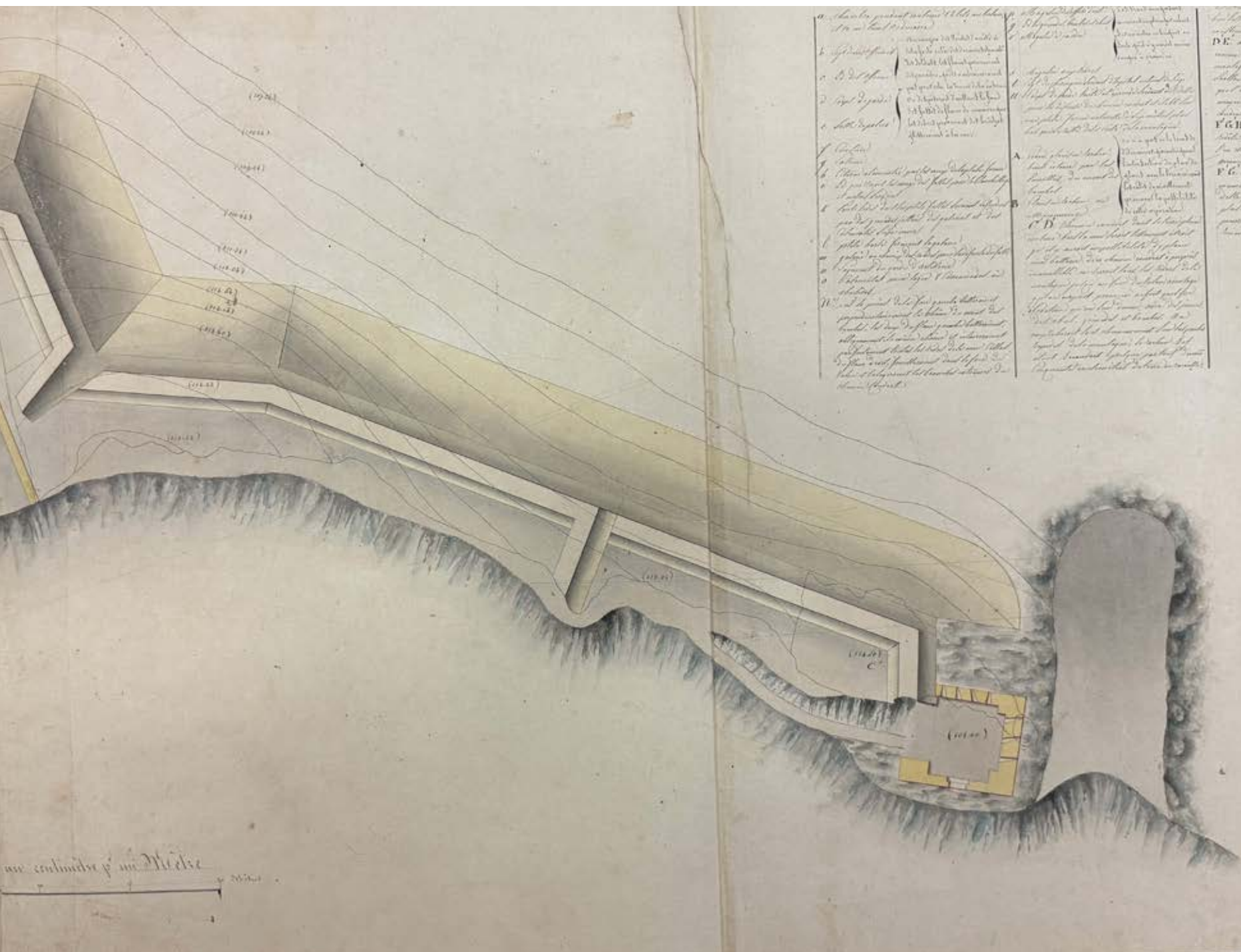
Fig. 127 - Nuova planimetria del progetto del Forte di Monte Albero, su cui viene ipotizzata una nuova soluzione più raccolta e meno sviluppata in lunghezza. Anno 1812. Istituto Storico e di Cultura dell'Arma del Genio di Roma (ISCAG).
